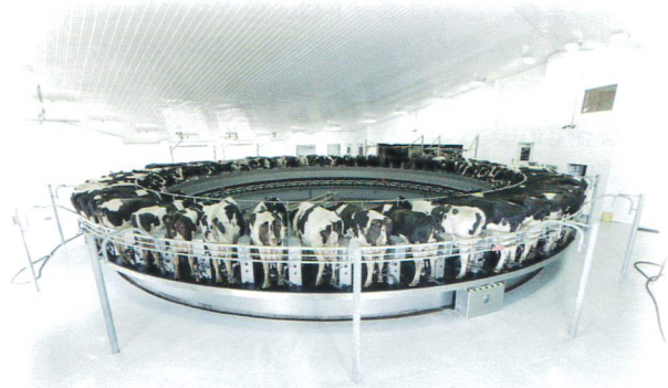
ロータリーパーラー搾乳機「PR-3100HD」。ストール数 32 頭～100 頭まで、飼育数の規模に応じたサイズを用意しています。
