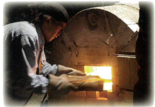
スウェーデンで2018年に行われた穴窯講座に参加した時の写真。窯の温度を上げるために薪を投入中です。
